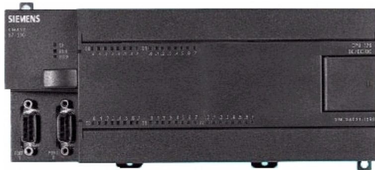
Obr. 6. Příklad PLC Simatic S7 – 200.
