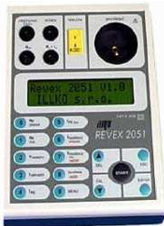
Obr.1 Měřicí přístroj REVEX 2051 pro kontrolu a revizi elektrických předmětů a nářadí.
