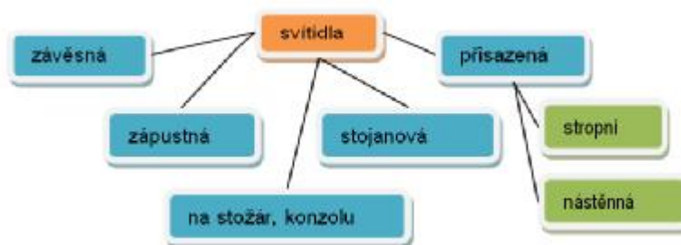
Obr. 8.8: Dělení svítidel podle typu montáže
