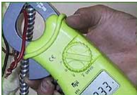
Obr. 2 - Praktické využití Hallova jevu u klešťového ampérmetru
