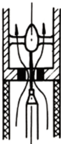
Obr. 8.3 – Omezení délky oblouku protielektrodou
