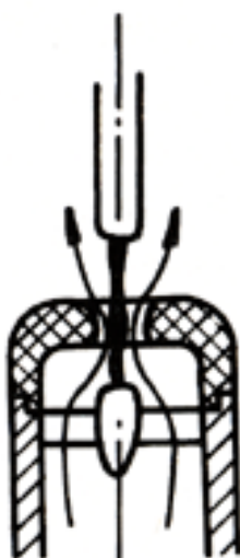
Obr. 8.6 – Provedení trysky z izolačního materiálu
