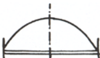
Obr. 12.7. – Rozložení teploty na pásku pojistky při vypínání nadproudu
