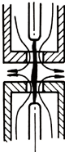
Obr. 8.4 – Konstrukce dvojité trysky
